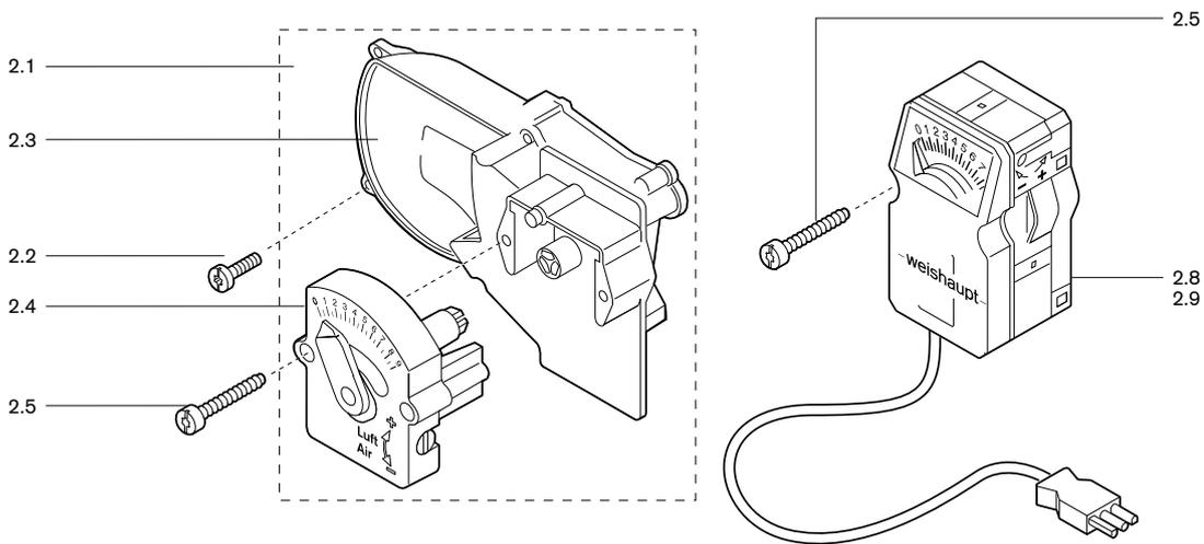
**3. Motor mit Kondensator, Gebläse / Motor with condensor fan / Moteur avec condensateur, turbine**
