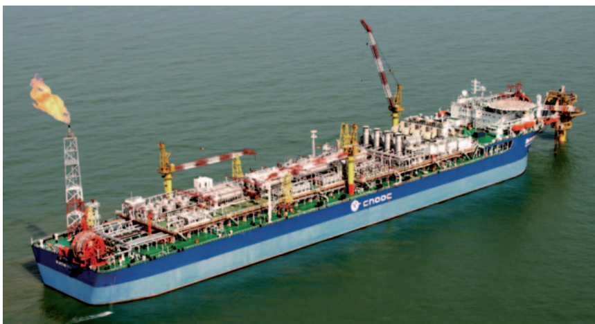
Auf zentralen Schiffsdepots wird das Rohöl der Bohrinseln im südchinesischen Meer zwischengelagert
