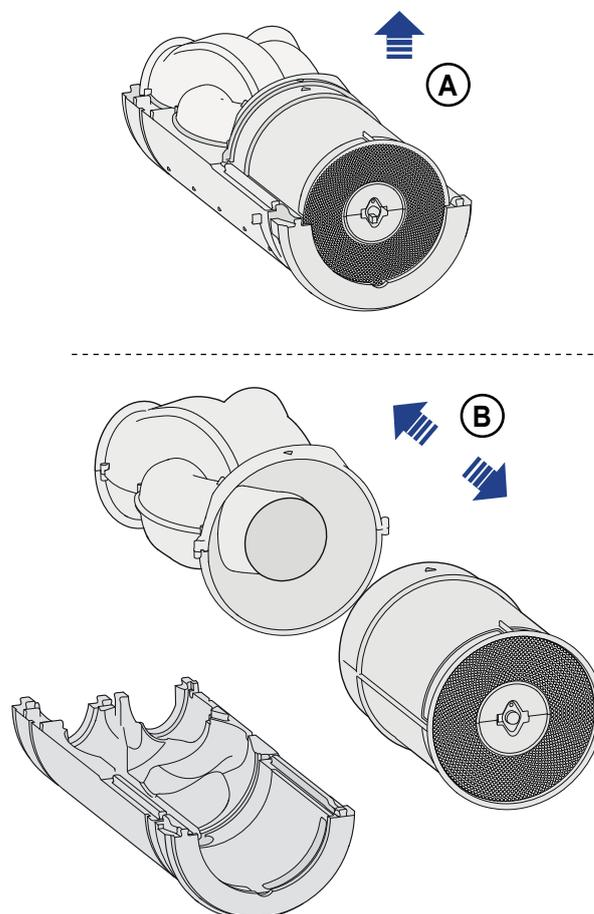
10 Mit einem Staubsauger und einer weichen Pinsel sowohl das Ventilatorteil wie auch den Wärmetauscher reinigen.
