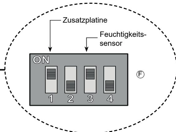
Wenn der RF-Sensor (Feuchtigkeitssensor) während einiger Minuten eine Zunahme der Luftfeuchtigkeit misst, wird die Lüftungsleistung automatisch auf Lüftungsstufe 5 erhöht.
