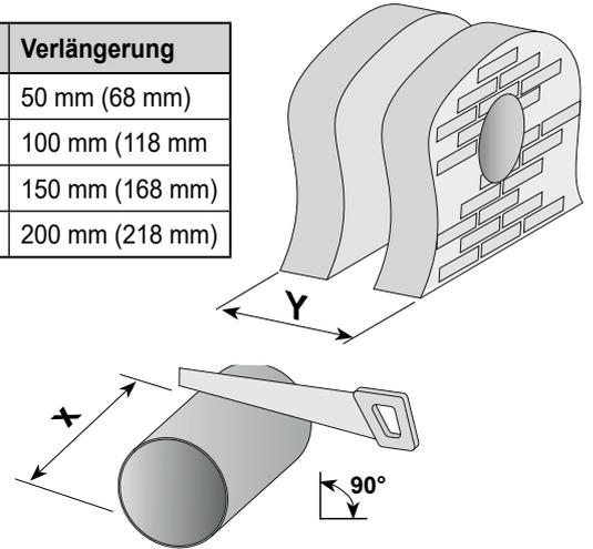
Mauerrohr auf Länge X ablängen.
