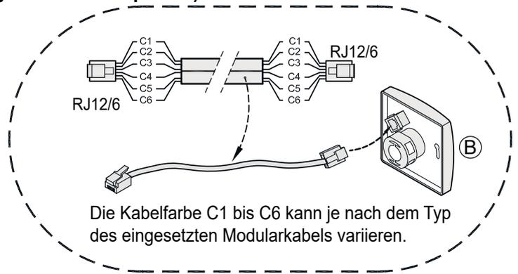
Die Kabelfarbe C1 bis C6 kann je nach dem Typ des eingesetzten Modularkabels variieren.
