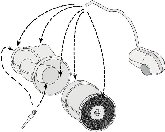
11 Sofern erforderlich mit geringem Druck (max. 0,5 bar) das Innere des Wärmetauschers reinigen.
