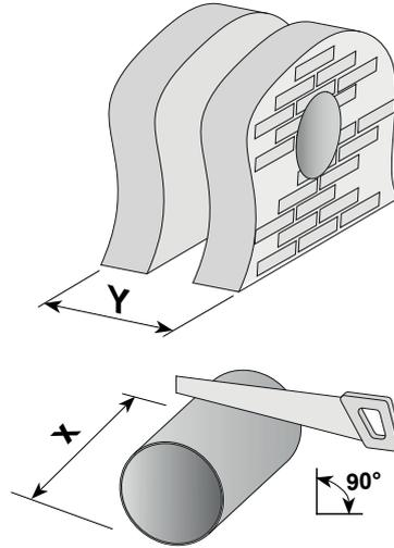
Mauerrohr auf Länge X ablängen.
