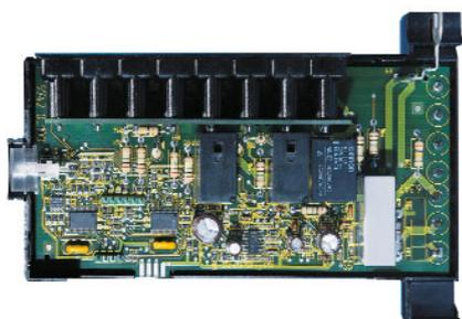
Alle Weishaupt W-Brenner sind serienmäßig mit digitalem Feuerungsmanagement ausgestattet. Sämtliche Brennerfunktionen werden dabei von leistungsfähigen Mikroprozessoren gesteuert und überwacht. Die Konsequenz: Weishaupt W-Brenner sind komfortabel, präzise und sicher.
