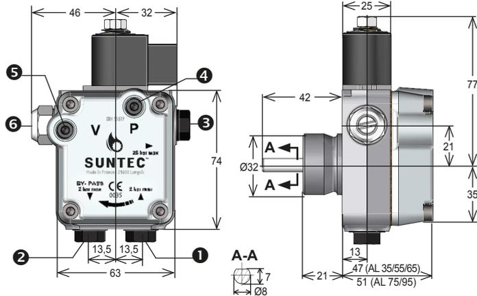
Zulauf ① und Rücklauf ② mit Direktverschraubung für Revision 6 Modelle (Abdichten mit Flachdichtung auf Ansenkung möglich)
