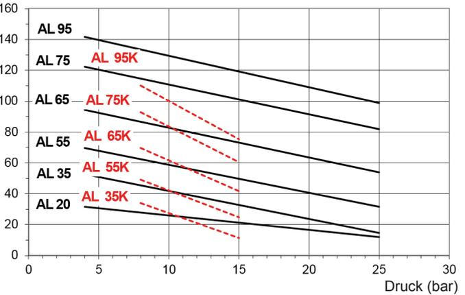
In den dargestellten Kurven ist bereits eine Abnutzung des Getriebes berücksichtigt. Achten Sie deshalb darauf, daß Sie bei der Wahl der Getriebekapazität, die Pumpe nicht überdimensionieren.
