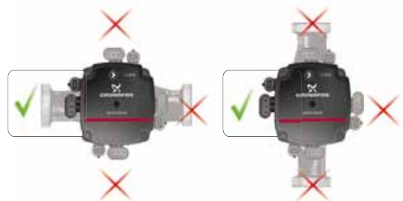
Abb. 6 Position des Schaltkastens, ALPHA SOLAR
