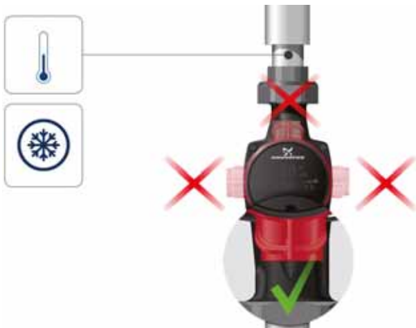
Abb. 4 Position des Schaltkastens in Klima- und Kaltwasseranlagen
