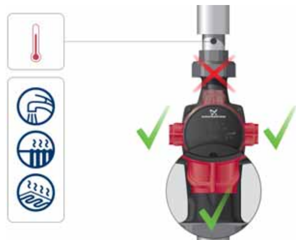
Abb. 3 Position des Schaltkastens in Heizungs- und Trinkwarmwasseranlagen
