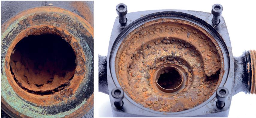
Metallteile in der Heizungsanlage können unter ungünstigen Bedingungen stark rosten.
