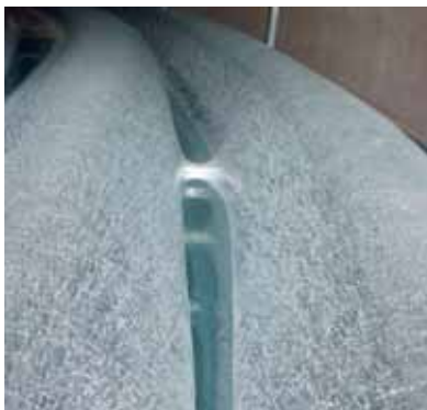
Eisbildung um den Wärmeübertrager im Eis-Energiespeicher
