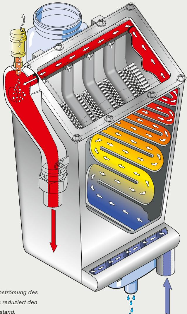
Die Paralleldurchströmung des Wärmetauschers reduziert den Strömungswiderstand.
