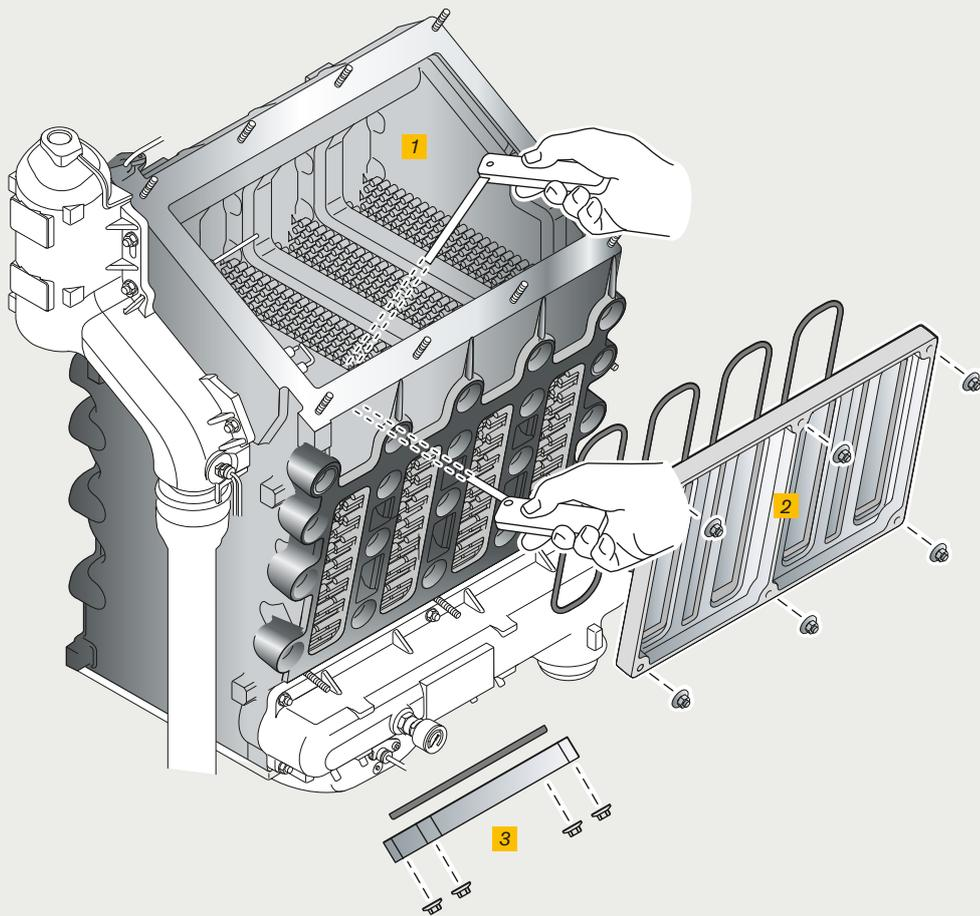
Große Revisionsöffnungen erleichtern Reinigungsarbeiten erheblich.
