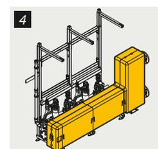
*Dank des umfangreichen Montagezubehörs ist der Aufbau einer Kaskadenanlage in wenigen Schritten erledigt.*
