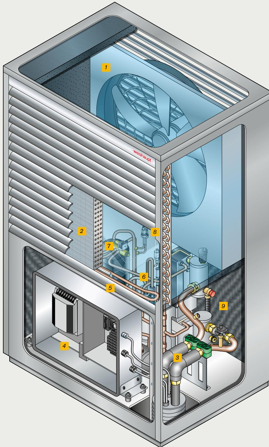
**1** Hocheffizienzgebläse mit aerodynamisch optimiertem Ventilator und Energiesparmotor.
