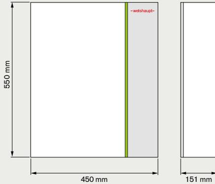
Mit dem separaten Wandregler lassen sich auch komplexere Anlagen mit mehreren Heizkreisen bedienen.
