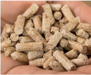
Der Betrieb des Festbrennstoffkessels für Holzpellets funktioniert ganz ohne Nachlegen. Die Presslinge sind genormt und lassen sich einerseits automatisch zur Brennkammer befördern und andererseits genau dosieren. So wird stets nur die benötigte Menge an Wärme erzeugt. Mit dem hohen Energiegehalt des Brennstoffes und der innovativen Heiztechnik erreichen Pelletkessel der Marke Viessmann einen Wirkungsgrad von über 95 %.
