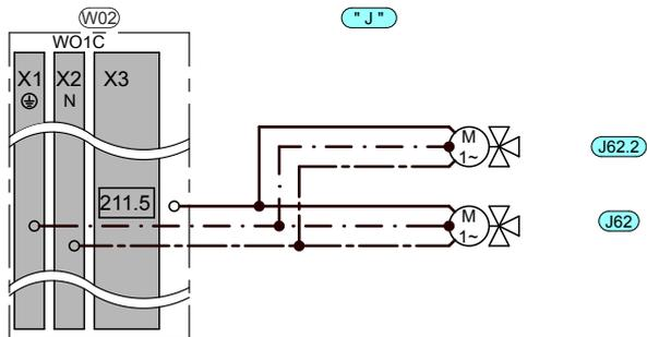
Elektroplan Zubehör: Anschlussbeispiel für ein Umschaltventil mit Dauerphase
