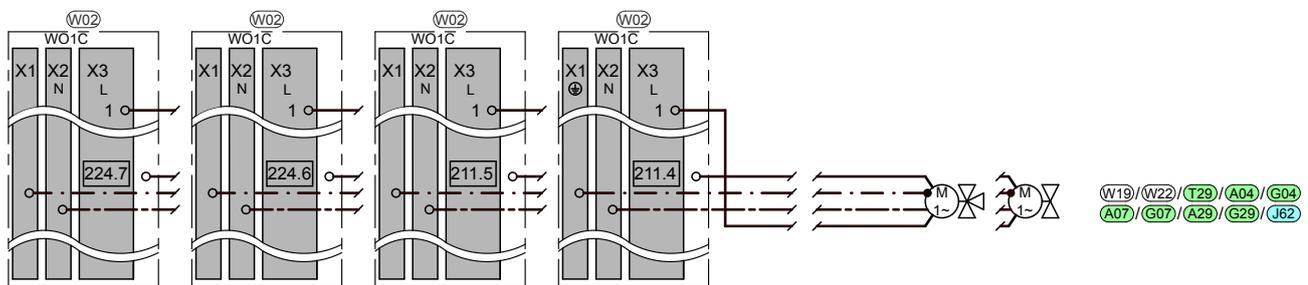
Elektroplan Zubehör: Anschlussbeispiel für ein Umschaltventil mit Federrücklauf
