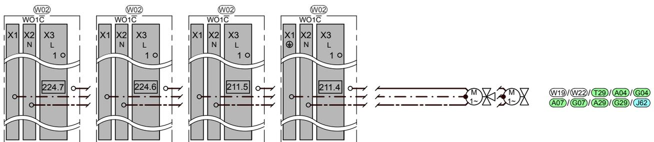
Elektroplan Zubehör: Anschlussbeispiel für ein Umschaltventil mit 2 Spulen, Ansteuerung über Hilfsschutz
