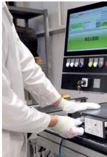
Prüfung eines Batteriemoduls in der Fertigung
