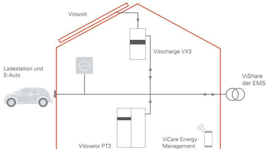
Perfekt kombiniert: Der selbst erzeugte Strom aus der Photovoltaik-Anlage und der Brennstoffzelle wird entweder gleich verbraucht oder im Stromspeicher zwischengespeichert und bei Bedarf abgerufen. Zusätzlicher Strombedarf wird innerhalb der ViShare Energy Community der EMS ergänzt.
