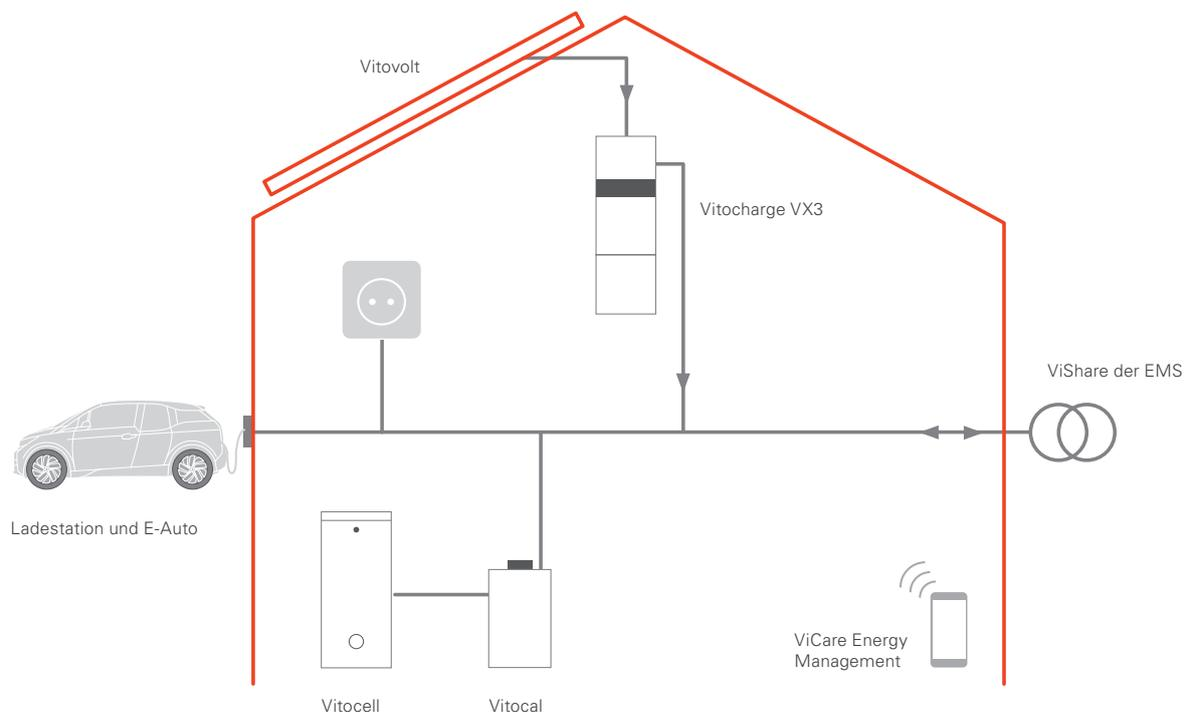
Strom von der Sonne, Wärme aus der Umwelt: Die Kombination Photovoltaik-Anlage und Wärmepumpe ist ideal für hohe Eigenstromnutzung.
