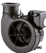
**ER EC – Robuster, volumenstromkonstanter, energiesparender und schalloptimierter EC Motor.** Geringe Leistungsaufnahme. Für Unterputz und Aufputz einsetzbar. Lüftungslösung nach DIN 18017-3 (Einrohrentlüftung). Schutzart IP X5, Einbau in Schutzzone 1 möglich. Der Ventilatoreinsatz ER EC kann mit den vier vorhandenen Abdeckungen ER-A, ER-AK, ER-AH, ER-AB kombiniert werden.
