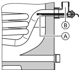
Anordnung des Speichertemperatursensors im Heizwasserrücklauf HR<sub>s</sub>
