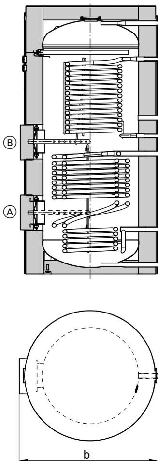
Die Ladelanze kann wahlweise an Position (A) oder (B) eingebaut werden.
