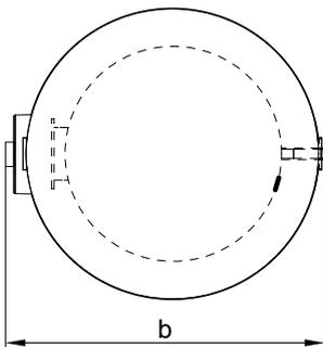
Der Elektro-Heizeinsatz kann wahlweise an Position (A) oder (B) eingebaut werden.
