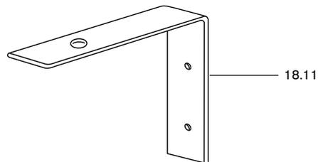
Kollektor-Anschluss-Set WTS -F1 / Panel connection set WTS -F1 / Set de raccordement capteur WTS -F1
