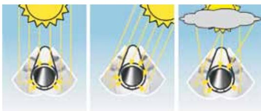
Der CPC-Spiegel (Compound Parabolic Concentrator) erhöht die Effizienz der Röhren durch seine Spiegelgeometrie. Durch diese fällt auch diffuses Sonnenlicht bei einem ungünstigen Einstrahlwinkel auf den Absorber.
