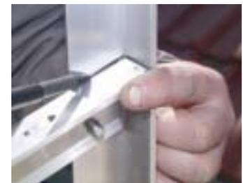
Diagonalen Schenkel je nach gewünschtem Winkel in der entsprechenden Bohrung am senkrechten Schenkel montieren.
