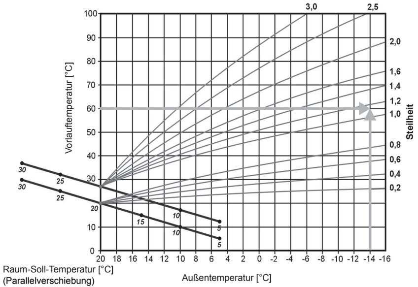
Die Raumsolltemperatur wird durch den Parameter „Tagtemperatur“, „Spartemperatur“ und die Stellung des rechten Drehknopfes (Temperaturwahl) beeinflusst.
