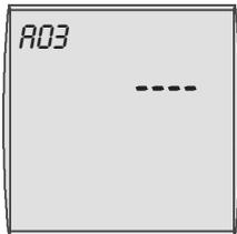
**Dieser Parameter wird nur angezeigt, wenn der Parameter A01 „Aufheizoptimierung“ auf 2 („raumtemperaturabhängige Aufheizoptimierung“) eingestellt ist.**
