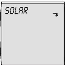
**Ist kein Solarmodul angeschlossen, wird die Menüebene Solar nicht angezeigt.**
