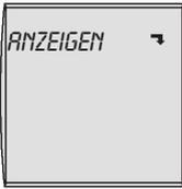
Es können alle verfügbaren Ist-/Solltemperaturen, Betriebsstunden und sonstige Anlagenwerte angezeigt werden. Diese Abfrage ist identisch mit der „Infotaste“.
