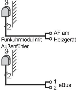
Bauseitige Zuleitung des Außentemperaturfühlers mit dem in der Heizgeräte-Regelung mitgelieferten Stecker verbinden. Stecker in den beschrifteten Platz der Steckerleiste der Heizgeräte-Regelung stecken und Kabel mit Zugentlastung sichern. Kabel durch die Aussparung in der Heizgeräte-Verkleidung führen. Außentemperaturfühler an der Nord- oder Nordostwand 2 bis 2,5 m über dem Boden montieren (Kabeldurchführung nach unten).
