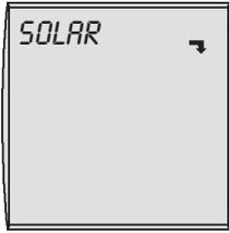
**Bei reiner Heizkreisregelung (kein Solarkreis vorhanden) wird die Menüebene Solar nicht angezeigt.**
