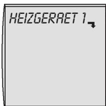
Über das Bedienmodul BM können die Parameter des Wärmeerzeugers (z.B. maximale Kesseltemperatur, Eingang 1, Ausgang 1) eingestellt werden.
