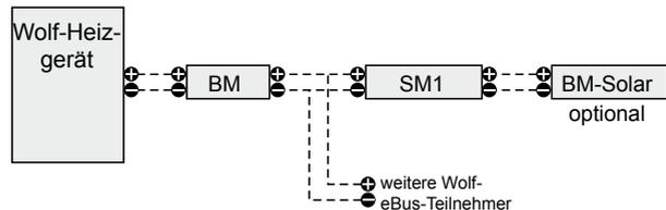
Falls der Solarspeicher einem anderen BM zugeordnet ist, ist die Bedienung auch von diesem BM möglich (vgl. Parameterbeschreibung *50L071 P07*).
