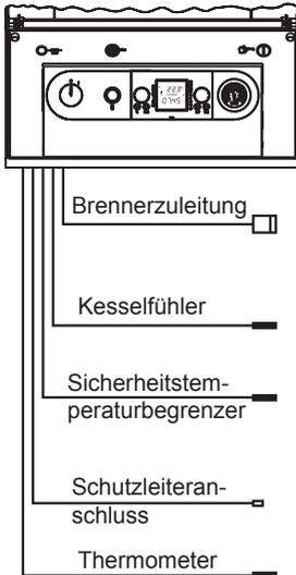
Bei der Montage der Regelung ist zu beachten, dass die Fühlerkapillaren nicht geknickt oder verdreht werden!
