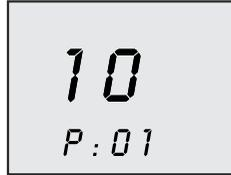
Durch Drehen des Drehknopfes können dann alle weiteren verfügbaren Parameter nacheinander abgefragt werden.
