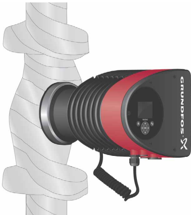
Abb. 4 Dämmen des Pumpengehäuses und der Rohrleitungen
