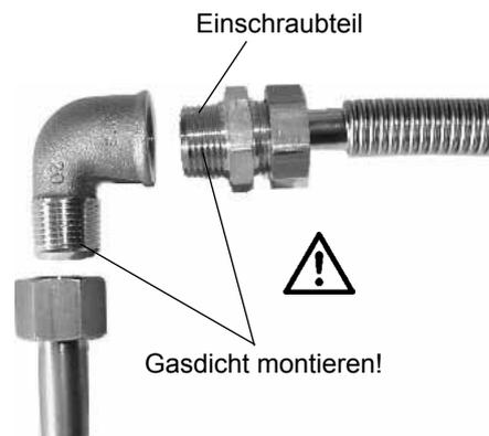
**Achtung** Es dürfen nur DVGW- bzw. DINDVGW zugelassene Dichtmittel z.B. Vliesbänder, Pasten, PTFE-Band verwendet werden.
