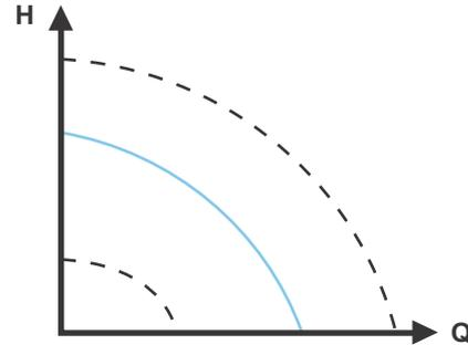
Abb. 20 Betrieb mit konstanter Kennlinie
