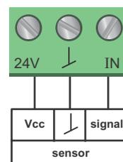
Abb. 42 Analogeingang für den Anschluss eines externen Sensors oder einer externen Steuerung
