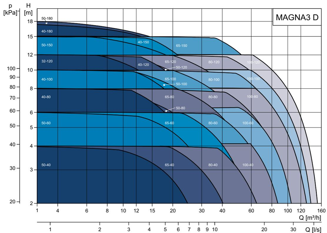
Abb. 4 Leistungsbereich der MAGNA3 D bei Parallelbetrieb (Doppelpumpenbetrieb)
