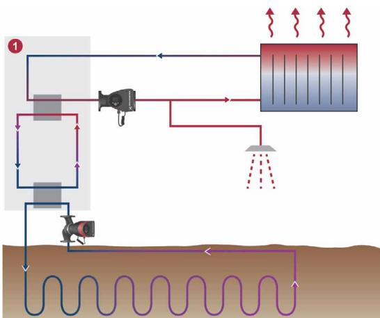
Abb. 10 Geothermische Wärmepumpenanlage in einem gewerblich genutzten Gebäude
