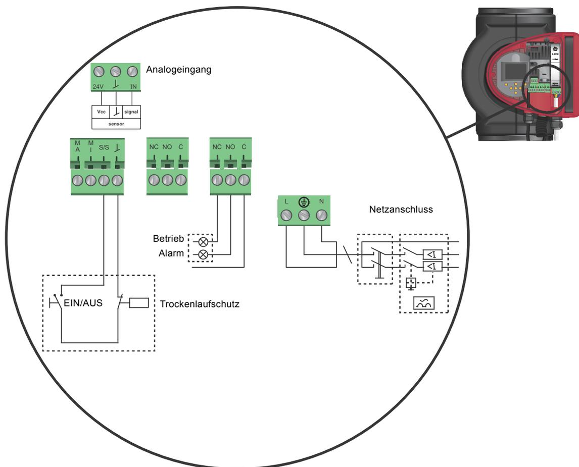
Abb. 39 Beispiel für mögliche Anschlüsse innerhalb der Elektronikeinheit
