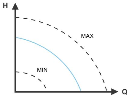
Abb. 11 MIN- und MAX-Kennlinie
