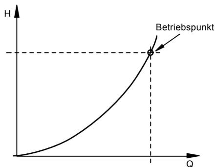
Abb. 5 Anlagenkennlinie
