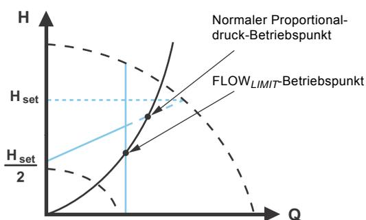
Abb. 23 Proportionaldruckregelung mit FLOW<sub>LIMIT</sub>
