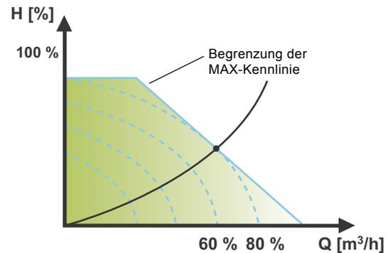
Abb. 21 Begrenzung der MAX-Kennlinie durch Leistungs- und Druckgrenzen
