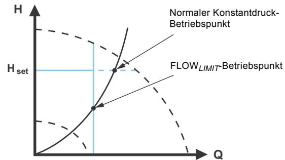
Abb. 24 Konstantdruckregelung mit FLOW<sub>LIMIT</sub>
