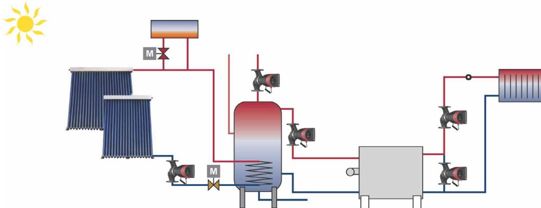
Abb. 9 Funktionsskizze einer Solarwärmeanlage
