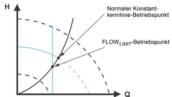
Abb. 25 Konstante Kennlinie mit FLOW<sub>LIMIT</sub>
