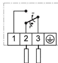
Umschaltung und Verriegelung bei fallendem Druck.
