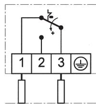
Umschaltung und Verriegelung bei steigendem Druck.
