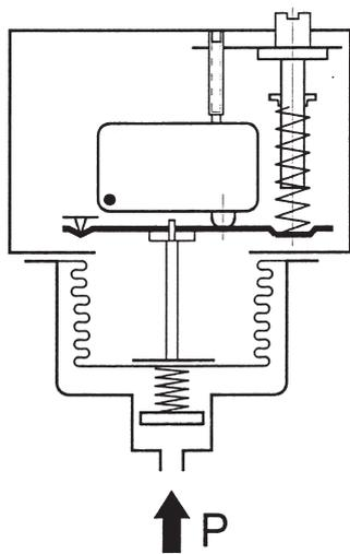
Druckbegrenzer ohne Sicherheitsmembran (nicht selbstüberwachend bei Maximaldrucküberwachung) DWR...
