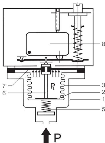
Selbstüberwachender Maximaldruckbegrenzer mit Sicherheitsmembran DWAM..., DWAMV..., SDBAM...
