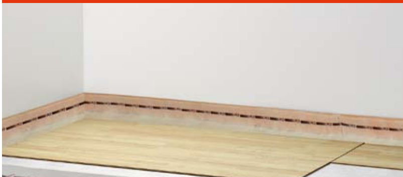
Abb. 34: Aufbringen des Bodenbelags
